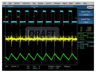
Figure 15. L=GLK2510P-2R2M, C=Ceramic 10µF 0603 X5R YAGEO (Ripple 13.2mV)
