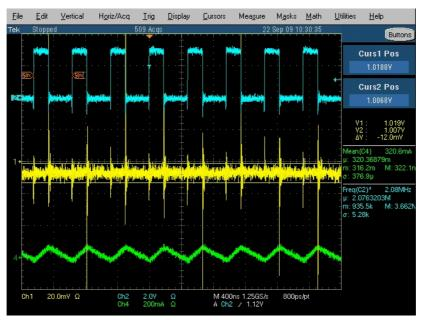
Figure 16. L=GLK2510P-4R7M, C=Ceramic 4.7µF 0805 X5R TDK (Ripple 12mV)
