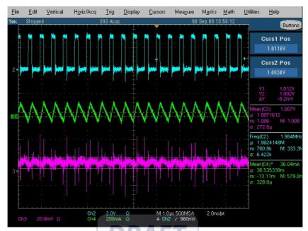
Figure 18. L=GTSD32P-2R2M, C=Ceramic 4.7µF 0805 X5R TDK (Ripple 9.2mV)
