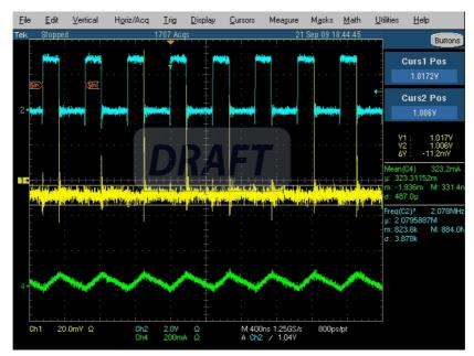
Figure 17. L=GLK2510P-4R7M, C=Ceramic 10µF 0603 X5R YAGEO (Ripple 11.2mV)
